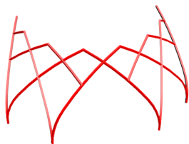
شکل ۳: مراحل ترسیم کاربردی چهارده ضلعی (دو پا قالب شاغولی مشتک شکسته) و ترسیم کاربردی حمام رهنان اصفهان به عنوان نمونه (نگارندگان، ۱۳۹۶).
