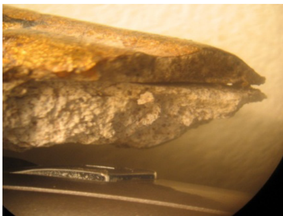
تصویر ۷: جدایش بین لایه‌ها در زیر طلای برجسته‌کاری شده است
