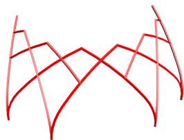
شکل ۳: مراحل ترسیم کاربردی چهارده ضلعی (دو پا قالب شاغولی مشتک شکسته) و ترسیم کاربردی حمام رهنان اصفهان به عنوان نمونه (نگارندگان، ۱۳۹۶).
